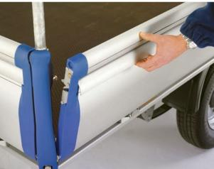
Pour libérer les ridelles, il suffit d'exercer une légère pression vers l'intérieur en soulevant la poignée avec les doigts. Les ridelles ne seront libérées que si l'on pousse dessus avant de soulever la poignée. (Par sécurité, le simple soulèvement de la poignée ne libérera pas les ridelles).
