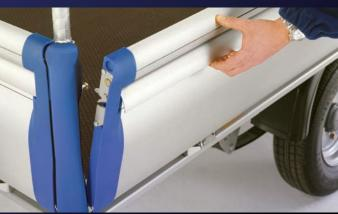
Pour libérer les ridelles, il suffit d'exercer une légère pression vers l'intérieur en soulevant la poignée avec les doigts. Les ridelles ne seront libérées que si l'on pousse dessus avant de soulever la poignée. (Par sécurité, le simple soulèvement de la poignée ne libérera pas les ridelles).
