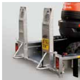
Rampes réglables de chargement, béquilles intégrées
