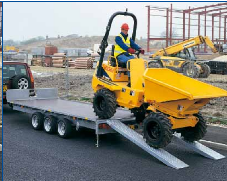
LM166 Triple essieu avec options : ridelles avant, treuil électrique, rampes de chargement, béquilles, et sangles d'arrimage.
