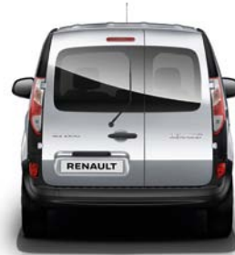
Portes arrière asymétriques vitrées avec essuie-lunette et désembuage
